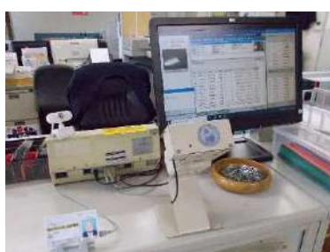
アルコール検知器 免許証読取装置新設
